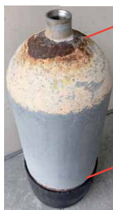
① タンク外側がサビていないか
