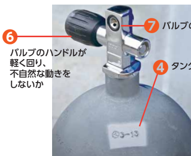
② タンク外側のタンクブーツ接触部が帯状に錆びていないか
