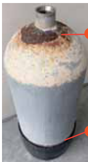
① タンク外側がサビていないか
